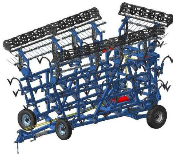
Рисунок 5 – КСОП-10 с шлейфом КПП145В.00.000 в транспортном положении
