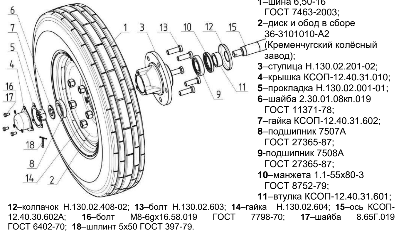
Рисунок 8 – Колесо КСОП-12.40.30.000А
